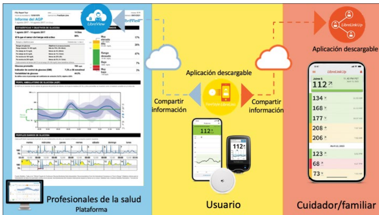
Figura 1. Sistema digital integral. El usuario/paciente puede descargar una aplicación en su smartphone o utilizar un lector para escanear el sensor del sistema flash de monitoreo de glucosa y compartir la información con el profesional de la salud a través de la nube para obtener los reportes con el perfil de comportamiento glucémico. El familiar/cuidador puede descargar una aplicación a su teléfono celular y recibir notificaciones sobre las lecturas de glucosa del usuario/paciente al compartir sus datos.
